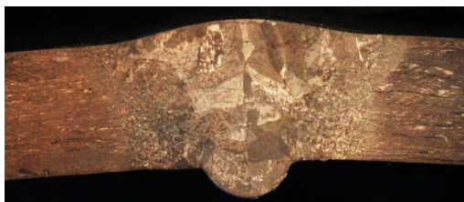
Рисунок 7 – Макроструктура сварного соединения детали с использованием подготовки кромок перед сваркой по схеме рис.2-б, \sim 2,6
