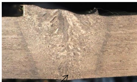
Рисунок 4 – Непровар в корне, \sim 4,3
