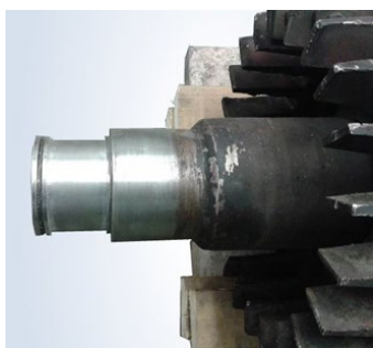
Рисунок 2 – Внешний вид опорной шейки после механической обработки до лазерной наплавки
