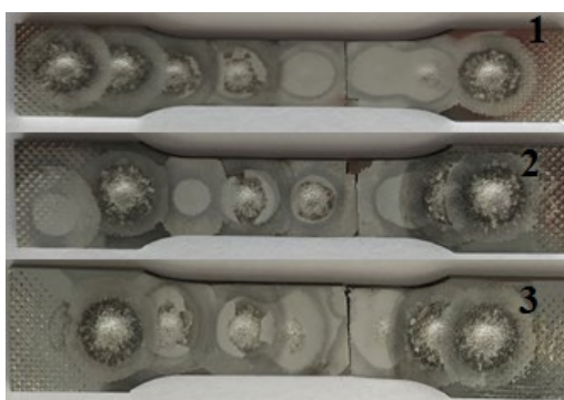
Рисунок 1 – Образцы из сплава BV751П после проверки химического состава
