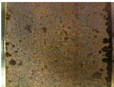
Рисунок 4 – Общий вид образца после испытания на сдвиг
