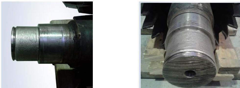
Рисунок 3 – Внешний вид опорной шейки ротора после лазерной наплавки
