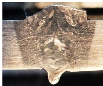
Рисунок 5 – Подрез и проплав, \sim 3,4
