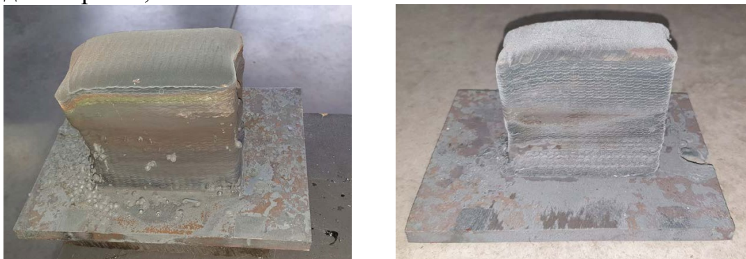
Рисунок 5 – Наплавленные образцы из материала ЭП609-Ш
