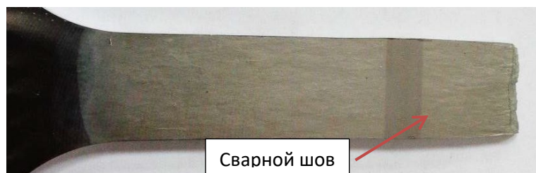
Рисунок 7 - Строение излома образца из сплава ВТ6ч после испытания на растяжение при 20°C
