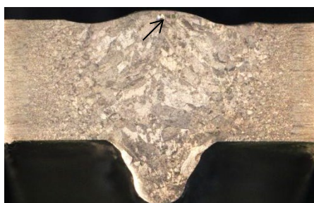
Рисунок 6 – Газовые поры, \sim 3,5
