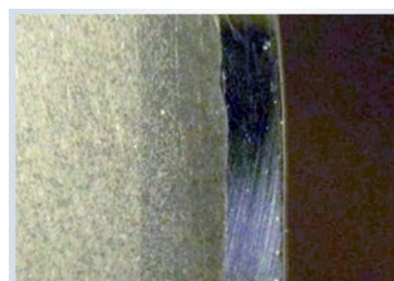
Рисунок 5 – Шлиф зоны сплавления и термического влияния наплавленного слоя после мехобработки
