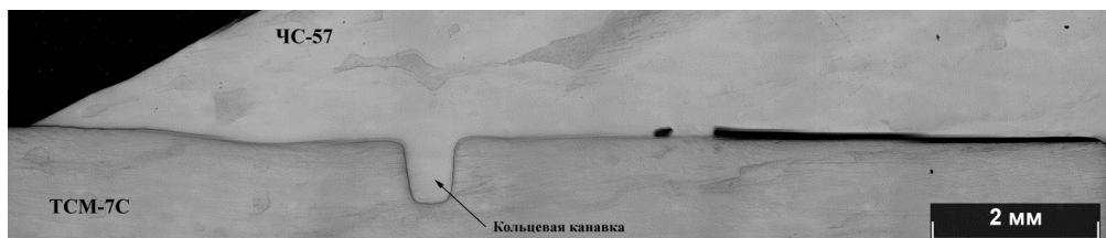
Рисунок 8 – Панорама сварного шва (медная вставка)
