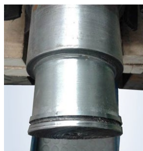
Рисунок 2 – Внешний вид опорной шейки после механической обработки до лазерной наплавки
