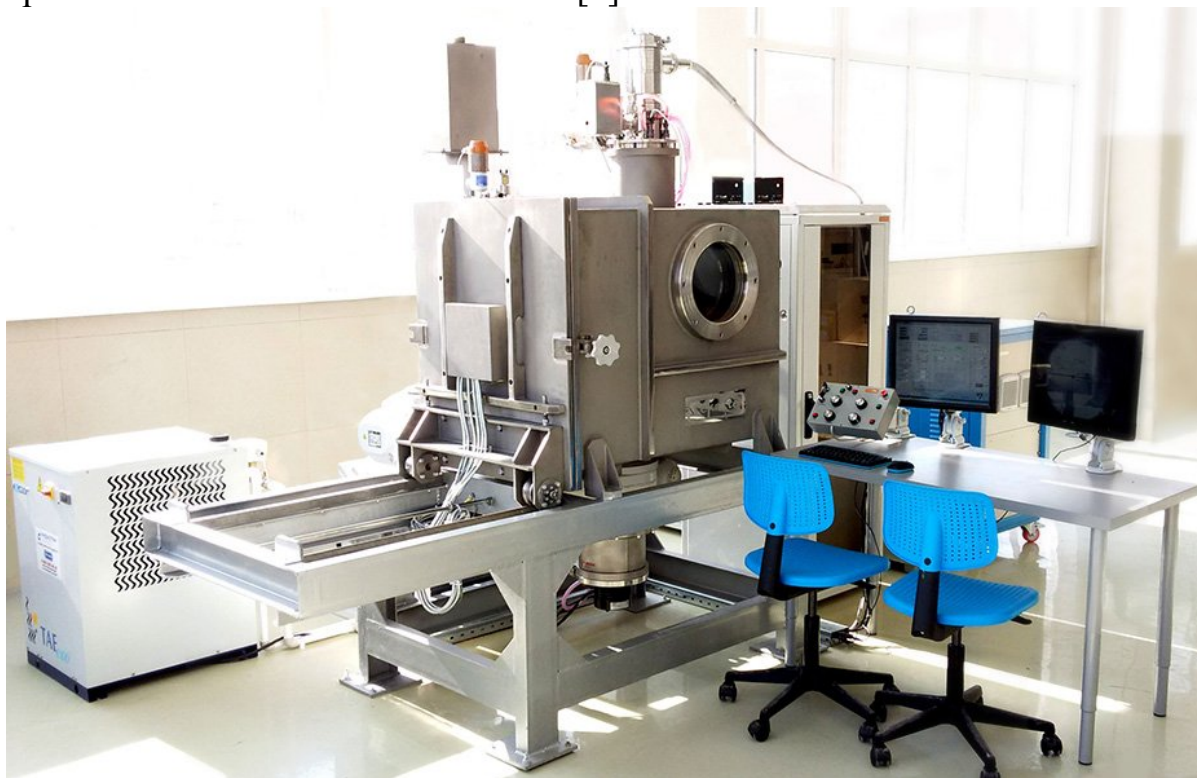
Рисунок 1 – Электронно-лучевая сварочная технологическая установка ЭЛСТУ-60.6ДП/0.5, предназначенная для сварки углеродистых сталей, титана, алюминия и их сплавов с безмасляной откачкой вакуумной камеры и использованием двойного преломления луча
